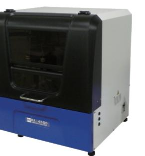
Thiết bị phân tích thủy ngân dạng vết (CVAAS) với công suất cao đáp ứng và vượt hơn cả các tiêu chuẩn thông thường như USEPA 245.1, 245.2, 7470A, 7471B, APHA-3112B, EN-1483, ISO-17846, ASTM D 3223, JIS K0102 và hơn nữa. Có bộ đưa mẫu tự động tới 80 chỗ hoặc xử lý phá mẫu bằng axit 80 vị trí.
